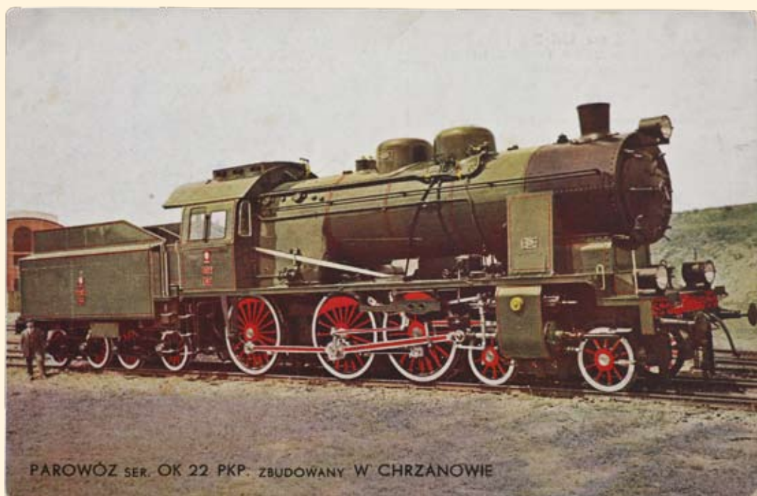
Ryc.152 Parowóz SER.OK.22 PKP dla pociągów osobowych i pędzących zbudowany w zakładach Pierwszej Fabryki Lokomotyw w Polsce S.A. Waga w stanie roboczym 133t., szybkość 100 km/g. Wyd. Fab-Lok „PFL” Pierwsza Fabryka Lokomotyw, 1930 r.
