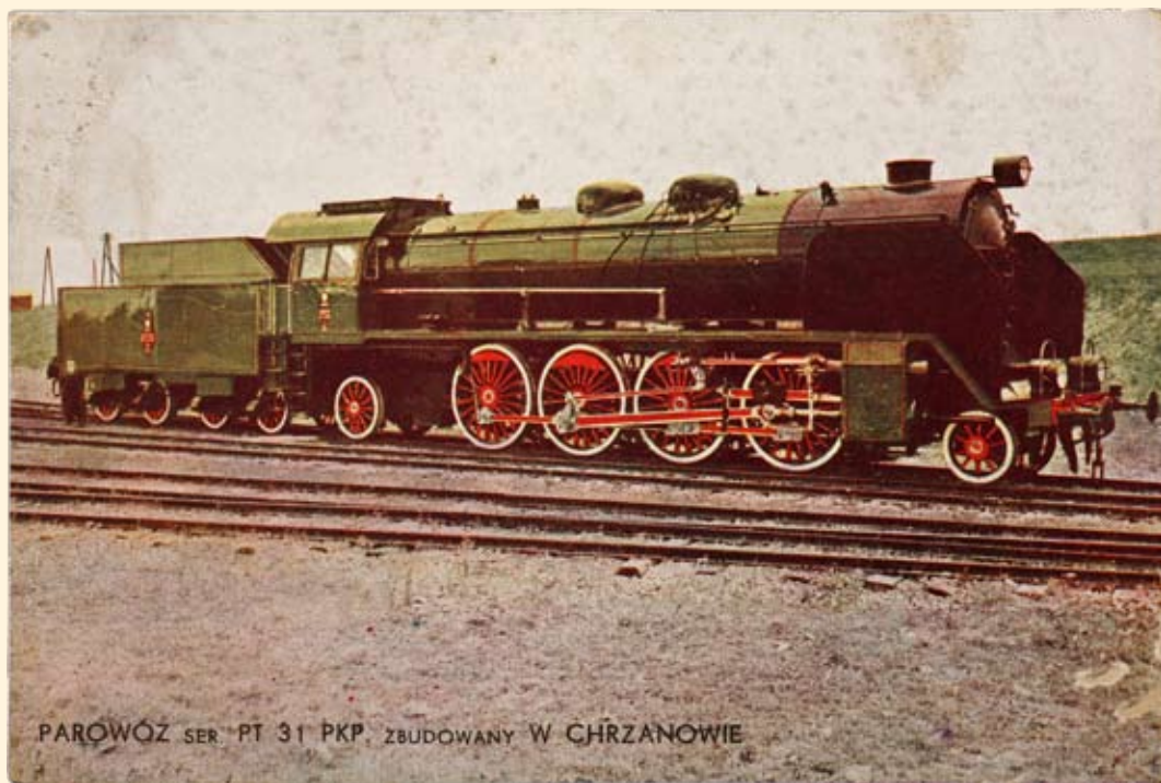
Ryc.155 Parowóz seria PT 31 PKP dla pociągów pośpiesznych zbudowany w zakładach Pierwszej Fabryki Lokomotyw w Polsce S.A. Waga w stanie roboczym 174t., szybkość 110 km/g. Wyd. Fab-Lok „PFL” Pierwsza Fabryka Lokomotyw, 1930 r.
