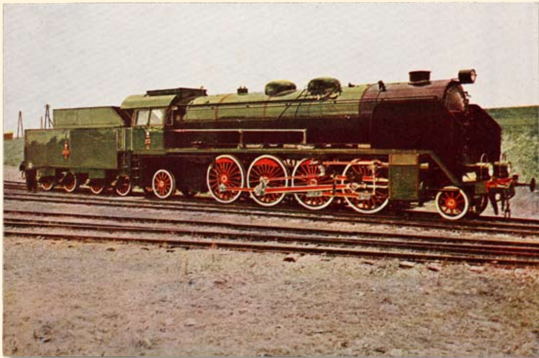
Ryc.154 Parowóz seria PT 31 PKP dla pociągów pośpiesznych zbudowany w zakładach Pierwszej Fabryki Lokomotyw w Polsce S.A. Waga w stanie roboczym 174t., szybkość 110 km/g. Wyd. Fab-Lok „PFL” Pierwsza Fabryka Lokomotyw, 1930 r.
