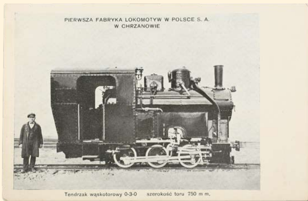
Ryc.151 Tendrzak wąskotorowy 0-3-0. Pow. ogrzewalna 32m 2 , pow. rusztu 0,70m 2 , ciśnienie pary 12atm., zapas wody 1,1m 3 , zapas węgla 0,6m 3 . Waga (próżna) 11,5t., waga (robocza) 14t., moc 90KM. Nakł. Fabryka Lokomotyw w Chrzanowie, 1927 r.
